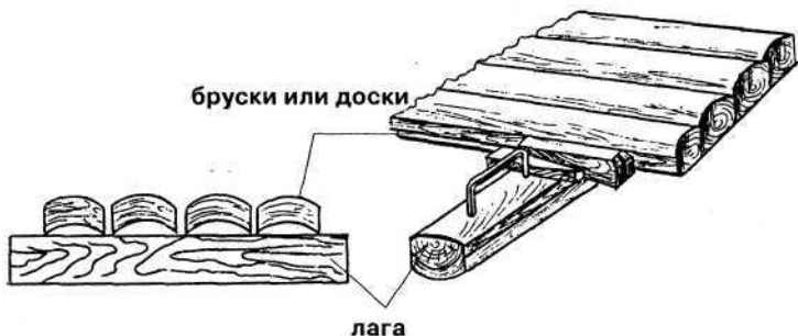
Рис. 16. Укладка брусков и досок выпуклой стороной вверх
