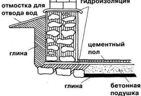
Рис. 12. Гидроизоляция фундамента
